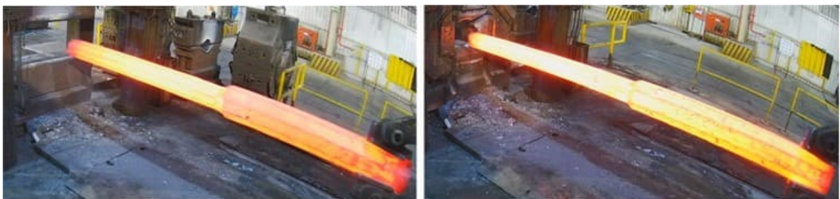
Figura 49 – Fotografias das barras no final do forjamento com 2 bigornas planas (esquerda) e com dispositivo 4DFD (direita).
