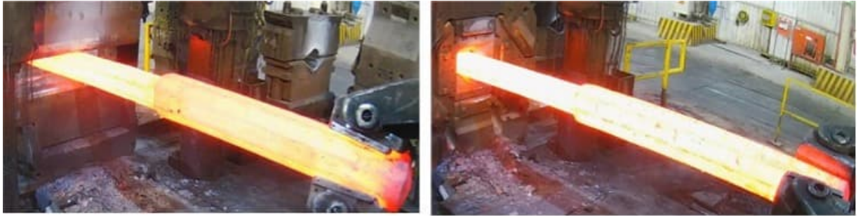
Figura 48 – Fotografias das barras durante o forjamento no formato oitavado de 250 mm com 2 bigornas planas (esquerda) e com dispositivo 4DFD (direita).
