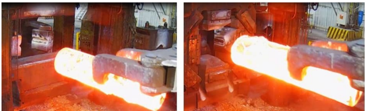
Figura 46 – Fotografias das barras de partida na entrada da prensa P3.000T para o forjamento com 2 bigornas planas (esquerda) e com dispositivo 4DFD (direita).
