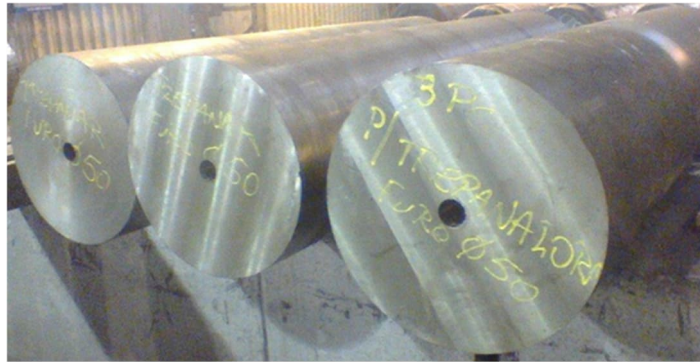
Figura 42 – Fotografia das barras na condição inicial: Øe 500 x Øi 50 x 2.000 mm.
