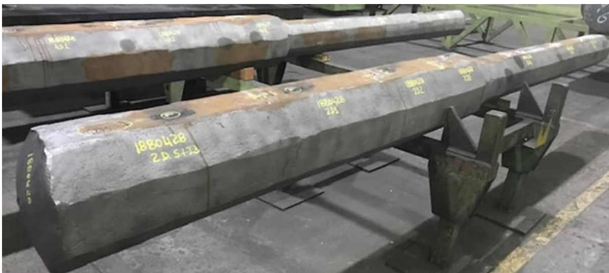
Figura 84 – Barras na bancada com as posições traçadas para os cortes em serra: barra acima com o dispositivo 4DFD; e abaixo forjada com 2 bigornas planas.
