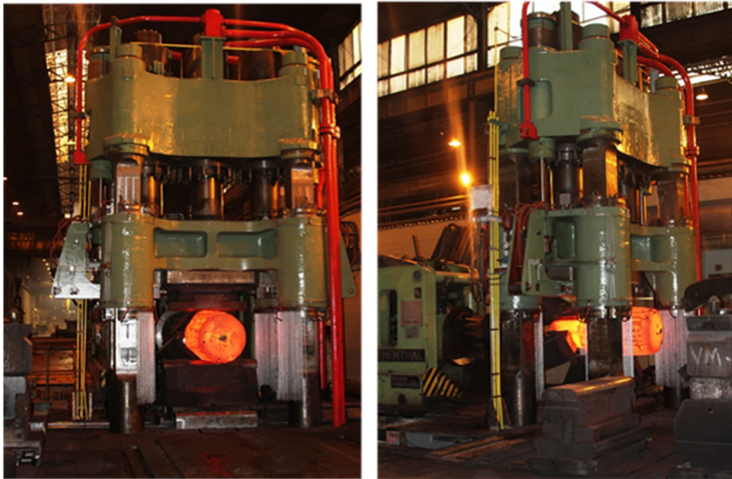
Figura 44 – Fotografias da prensa P3000T da Villares Metals SA, mostrando o forjamento convencional com 2 bigornas de um lingote, com vistas frontal e lateral.
