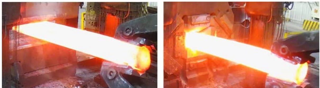
Figura 47 – Fotografias das barras durante o forjamento no formato oitavado de 350 mm com 2 bigornas planas (esquerda) e com dispositivo 4DFD (direita).
