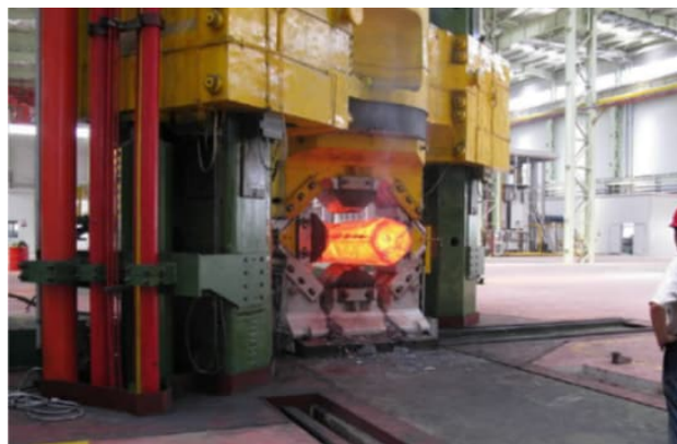
Figura 17 – Dispositivo 4DFD acoplado a prensa de 4.500 t em funcionamento. [12]
