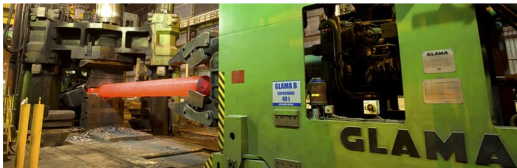
Figura 13 – Prensa hidráulica de matriz aberta de 5.000 t na empresa Villares Metals S.A. [6]
